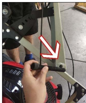
De geleidingsbalk monteren
