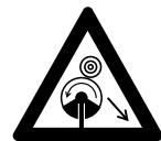
Bij gebruik van metalen snijgarnituren bestaat de kans op terugslag als het snijgarnituur een vast obstakel (boomstam, tak, boomstronk, steen of iets dergelijks) raakt. Het apparaat wordt hierbij teruggeslingerd – tegen de draairichting van het snijgarnituur in.
