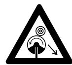
L'utilisation d'outils de coupe métalliques présente un risque de rebond, si l'outil entre en contact avec un objet solide (tronc d'arbre, branche, souche d'arbre, pierre etc.). La machine est alors projetée en arrière – dans la direction opposée au sens de rotation de l'outil.
