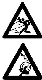
Examiner le terrain : des objets durs – pierres, morceaux de métal ou autres – peuvent se transformer en projectiles – **risque de blessure !** – et risquent d'endommager l'outil de coupe ou de causer des dégâts matériels (par ex. sur des véhicules garés, vitres etc.).
