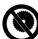
De beschermkap mag niet in combinatie met cirkelzaagbladen worden gebruikt.
