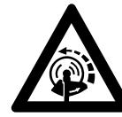
Das Schneidwerkzeug läuft noch kurze Zeit weiter, wenn der Gashebel losgelassen wird – **Nachlaufeffekt!**
