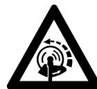
Lorsqu'on relâche la gâchette d'accélérateur, l'outil de coupe fonctionne encore pendant quelques instants – **par inertie** !
