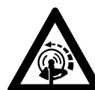
Het snijgarnituur draait nog even door nadat de gashendel wordt losgelaten – **naloopeffect!**
