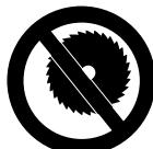
Il est interdit d'utiliser ce capot protecteur avec des scies circulaires.
