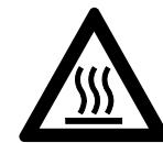
Das Getriebe wird während des Betriebes heiß. Getriebegehäuse nicht berühren – **Verbrennungsgefahr!**
