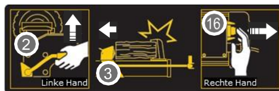
Fig. _ Tweehandenbediening: drukplaat beweegt terug
