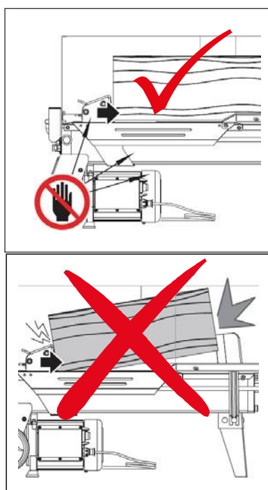
Fig. _ Defecte montage
